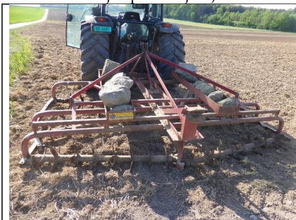
Recours à une vieille herse à bêtes roulantes (au lieu d'une herse rotative) pour le dernier travail du sol avant le semis du maïs et du soja. Senarclens VD, 07.05.2018.
